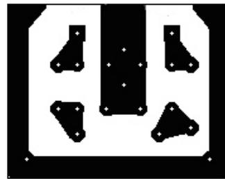
Da notare che il filtro va realizzato con la tecnica della *doppia faccia*, lasciando intatta la copertura di rame da un lato per realizzare il piano di massa.
